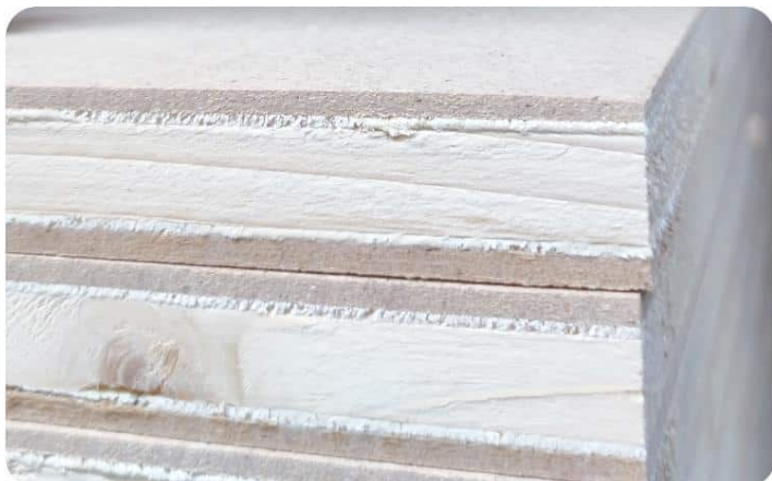
construction du panneau en 5 plis
