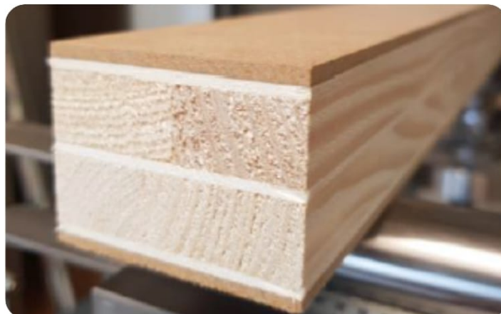
construction du panneau en 7 plis
